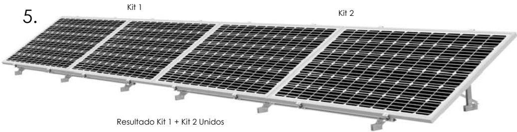
4.1 Montar estructura Kit 2 y unir a Kit 1 y fijar las uniones con los autotaladrantes 4.2 Montar los módulos repartiendo los vuelos a ambos lados por igual 4.3 Montar arriostramientos
