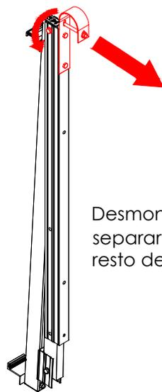
Desmontar el gancho superior y separar la base del triángulo del resto de elementos.
