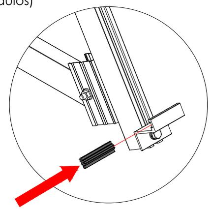
Según la inclinación que se desee para el triángulo, se deberá atornillar en una determinada posición marcada por los taladros existentes tanto en el montante como en el cordón inferior.
