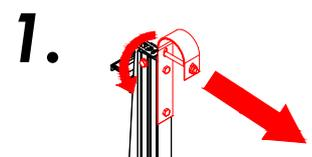
Desmontar el gancho superior y separar la base del triángulo del resto de elementos.
