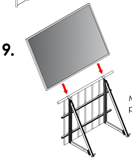
Montaje del módulo a presión en el presor de seguridad.
